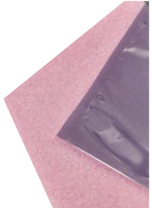
Links ein Polymerschaumstoff und rechts eine mit Aluminium bedampfte Folie. Beide wirken ableitend und sind in der Elektronikindustrie häufig eingesetzte Verpackungsmaterialien
